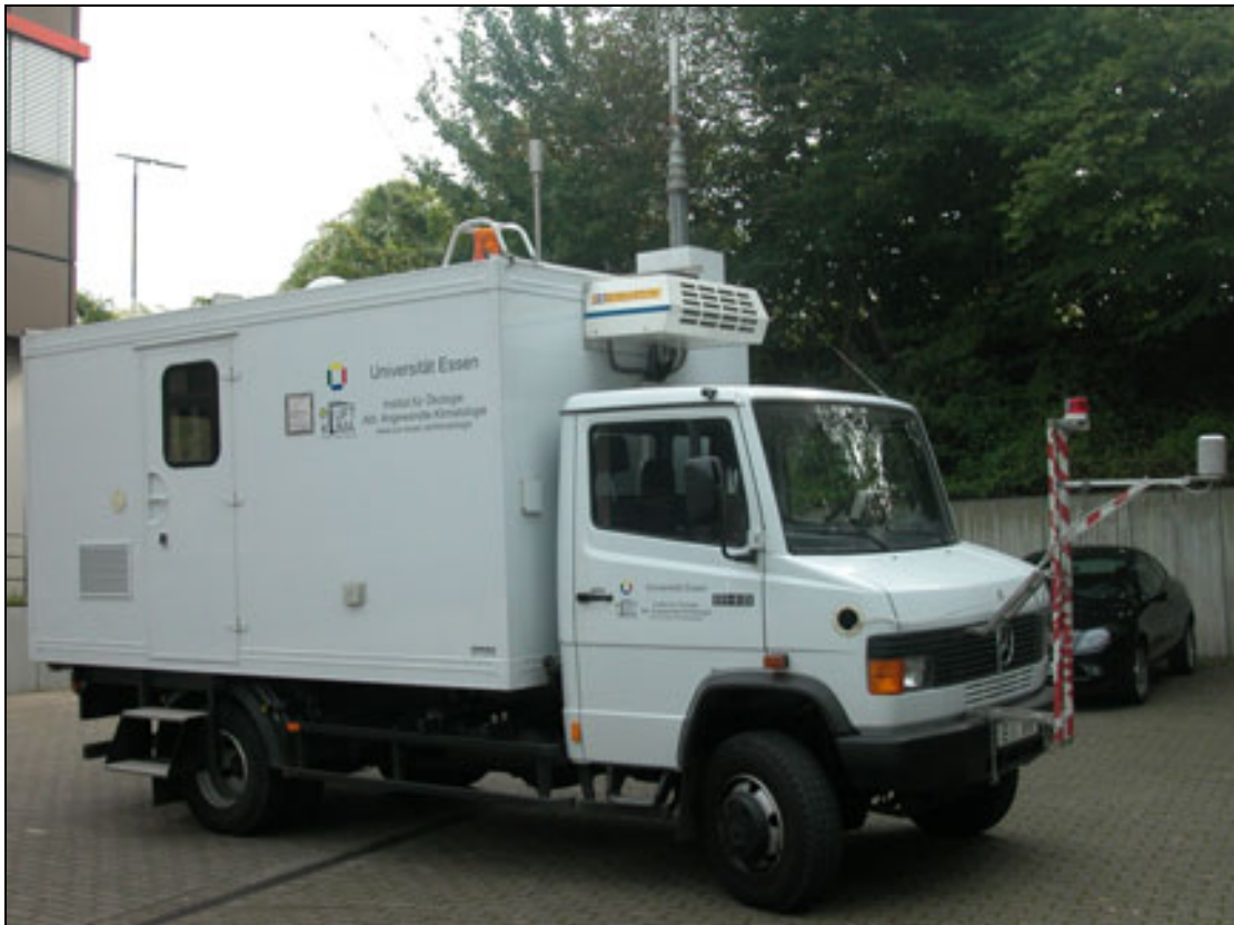
Abbildung 3: Messfahrzeug der Abteilung Angewandte Klimatologie und Landschaftsökologie zur mobilen Erfassung lufthygienischer und meteorologischer Größen.
