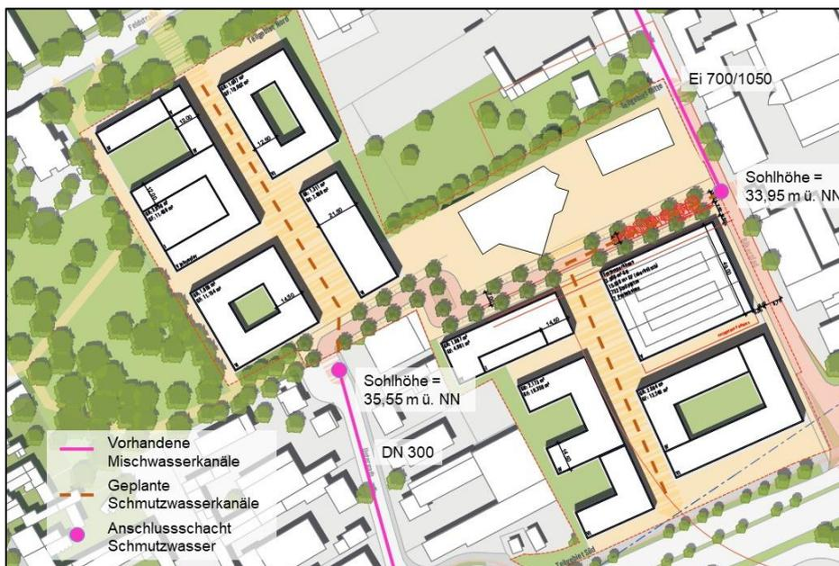
**Abbildung 9: Schmutzwasserkanäle bei Entwässerung über Baum-Rigolen (Darstellung mit dem städtebaulichen Konzept)**
