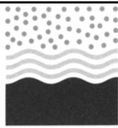
**Zeichnerische Darstellung von Bohrprofilen nach DIN 4023**
