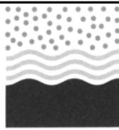
**Zeichnerische Darstellung von Bohrprofilen nach DIN 4023**
