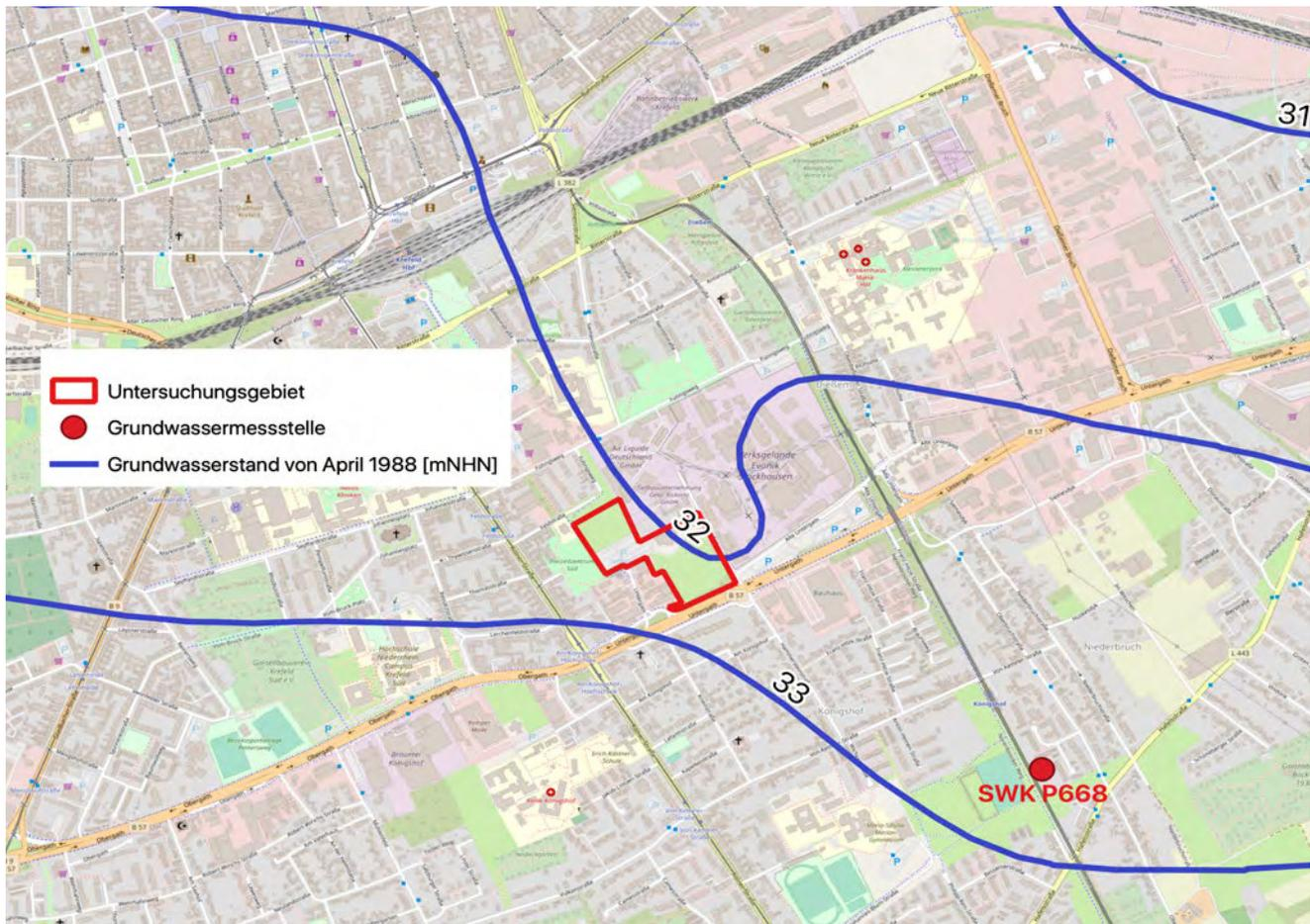
**Abbildung 4:** Grundwassergleichenplan April 1988 im Einzugsgebiet (Quellen: LANUV, ELWAS WEB, Openstreetmap)
