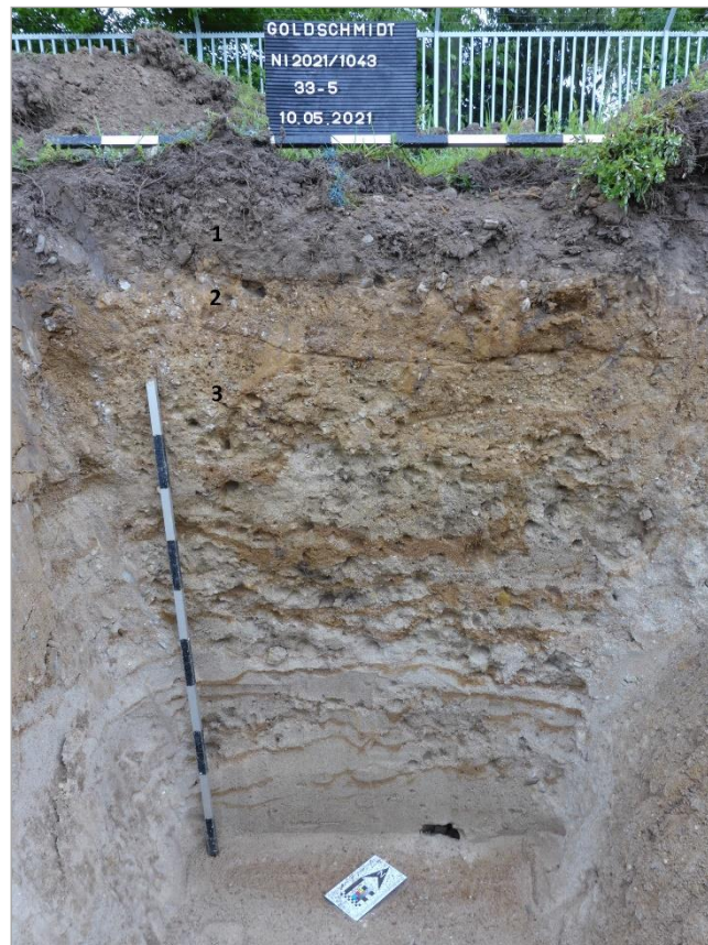
Abb. 03: Das Geoprofil Stelle 33, Bodenaufbau: Schicht 1: GOK 0-20 cm Oberboden (Ah), Schicht 2: 20-35 cm anstehender Terrassensand, Schicht 3: 35-135 cm Terrassensand (Foto: Tanja Baumgart).
