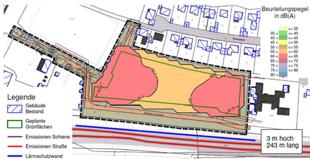
Lärmsituation mit LSW 3 m tagsüber - Peutz, Schalltechnische Untersuchung zum BP 830
