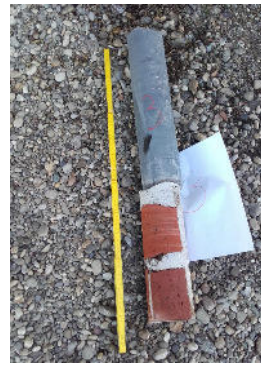
Bohrkern Nr. 3 aus Mau- erwerk und Basalt (86 cm)
