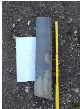
Bohrkern Nr. 5 aus Basalt geringer Dicke (50 cm)
