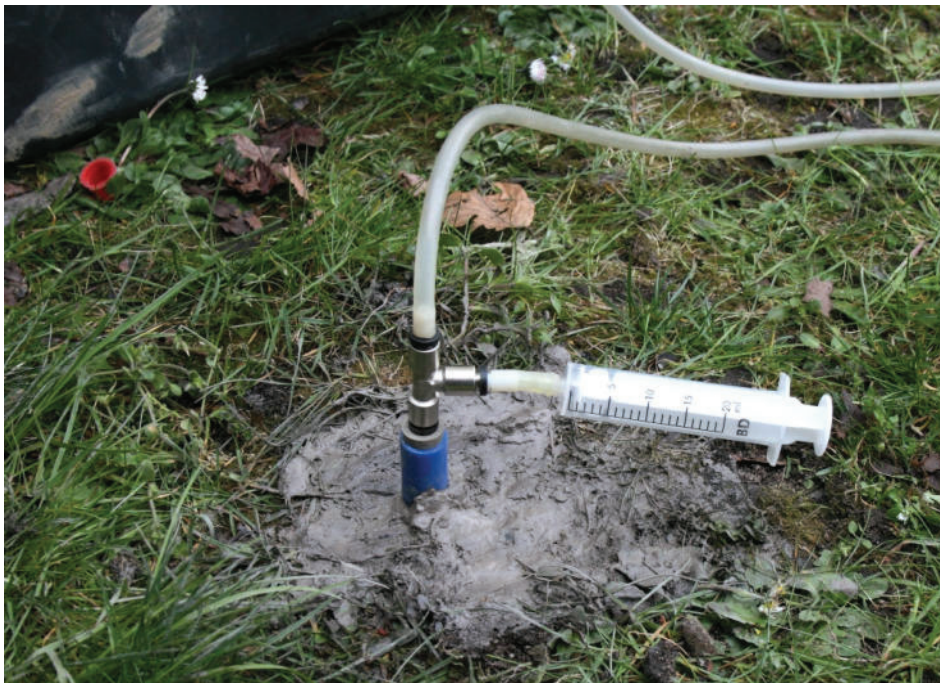
Abb. 8: Entnahme einer Bodenluftprobe aus der RKB 31/BL 15
