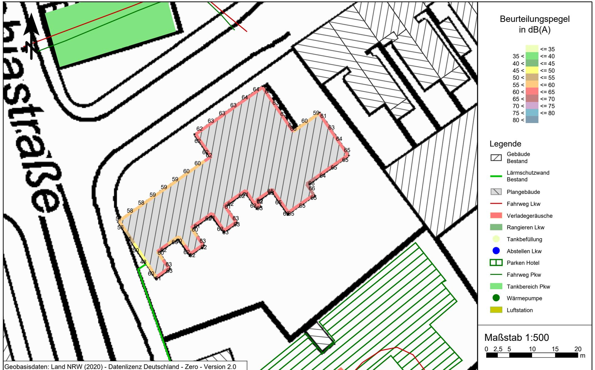
Anlage 5: Lageplan mit Darstellung der berücksichtigten Verkehrswege sowie der Immissionsorte an den Fassaden
